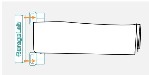
7. Lege die Aussenteile des Clips unter die schmalen Enden des Tuchs und klemme sie mit dem Keil fest, indem du ihn in die Führungswinkel schiebst.
